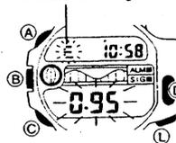
1. Halten Sie den Knopf (A) in dem Thermoscanner-Modus gedrückt, bis der Wert des Emissionsvermögens zu blinken beginnt, um damit die Einstellungsanzeige anzuzeigen.
