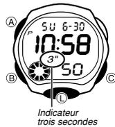
Une diode électroluminescente (LED) et un panneau à guide lumineux éclairent tout l'afficheur, qui de ce fait est parfaitement visible dans l'obscurité.
