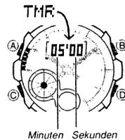
Der Countdown-Timer kann in einem Bereich von einer Minute bis zu 60 Minuten eingestellt werden. Ein Alarm ertönt, wenn der Countdown Null erreicht. Der Countdown-Timer weist auch eine Wiederholungsautomatik und einen akustischen Ablaufsignalgeber auf, der den Ablauf des Countdowns signalisiert.
