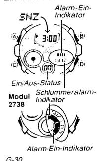
1. Verwenden Sie den Knopf (D), in dem Alarm-Modus, um einen Alarm zu wählen.
