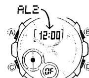
1. Verwenden Sie den Knopf (D) in dem Alarm-Modus, um durch die Alarmanzeigen zu scrollen, bis die gewünschte Anzeige erhalten wird, deren Zeit Sie einstellen möchten.
