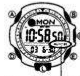
Automatische lichtschakelaar aan indicator
