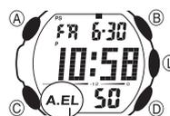
Ein-Indikator für automatischen Beleuchtungsschalter
