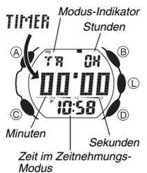
Sie können den Countdown-Timer in einem Bereich von 1 Minute bis zu 24 Stunden einstellen. Ein Alarm ertönt, wenn der Countdown Null erreicht.
