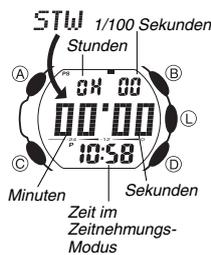
Die Stoppuhr lässt Sie die abgelaufene Zeit, Zwischenzeiten und zwei Endzeiten messen.
