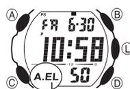
Il display dell'orologio è illuminato da un pannello elettroluminescente (EL) per una facile visione delle indicazioni al buio. La funzione di illuminazione automatica dell'orologio fa attivare automaticamente l'illuminazione quando si orienta l'orologio verso il proprio viso.
