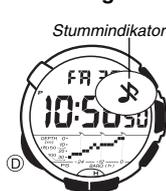
Wenn einer der Knöpfe der Uhr betätigt wird, ertönt ein Bedienungskontrollton. Dieser Kontrollton kann beliebig ein- und ausgeschaltet werden.
