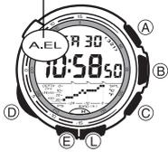
Die Uhr verwendet ein elektrolumineszentes (EL) Panel, welches das gesamte Display beleuchtet, sodass dieses auch im Dunkeln abgelesen werden kann. Der automatische Beleuchtungsschalter dieser Armbanduhr schaltet die Beleuchtung automatisch ein, wenn Sie die Armbanduhr unter einem bestimmten Winkel auf Ihr Gesicht richten.
