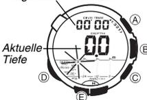
1. Bevor Sie mit einem Tauchgang beginnen, rufen Sie den Zeitnehmers-, Digitalkompass- oder Barometer/Thermometer-Modus auf, und drücken Sie danach den Knopf (C), um auf den Tiefenmesser-Modus zu schalten.
