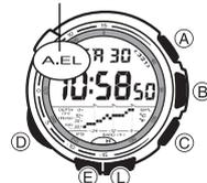
Este reloj dispone de un panel EL (electroluminiscente) que ilumina toda la presentación para facilitar la lectura en la oscuridad. El interruptor de luz automático del reloj ilumina automáticamente la presentación al inclinar el reloj hacia la cara del usuario.
