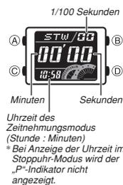
Die Stoppuhr lässt Sie die abgelaufene Zeit, Zwischenzeiten und zwei Endzeiten messen.
