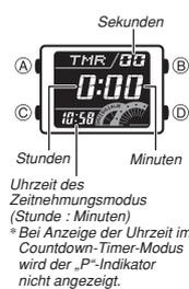
Der Countdown-Timer kann innerhalb des Bereichs von 1 Minute bis zu 24 Stunden eingestellt werden. Ein Alarm ertönt, wenn der Countdown Null erreicht.
