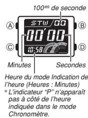
Le chronomètre permet de mesurer le temps écoulé, des temps partiels et deux arrivées.
