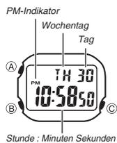
Der Uhrzeitmodus dient zum Anzeigen der aktuellen Uhrzeit und des Datums.
