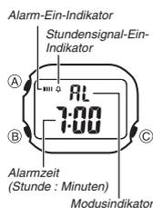
Wenn der Tagesalarm eingeschaltet ist, ertönt der Alarm täglich zur voreingestellten Zeit für 20 Sekunden. Wenn das Stundensignal eingeschaltet ist, piept die Uhr zu jeder vollen Stunde.
