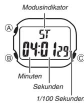
Im Stoppuhrmodus können Sie die abgelaufene Zeit, Zwischenzeiten und zwei Endzeiten messen. Der Bereich der Stoppuhr beträgt 59 Minuten 59,99 Sekunden.
