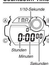
Der Countdown-Timer kann in einem Bereich von einer Sekunde bis zu 24 Stunden eingestellt werden. Ein Alarm ertönt, wenn der Countdown Null erreicht.
