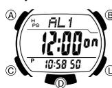
1. En el modo de alarma, utilice **(D)** para desplazarse a través de las pantallas de alarma hasta que se visualice la pantalla cuya hora desea ajustar.
