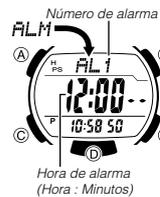
El modo de alarma le permite seleccionar entre cinco alarmas diarias, una de las cuales es una alarma con repetición.
