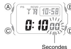
7. Utilisez les boutons (B) et (D) pour modifier le réglage des secondes.
