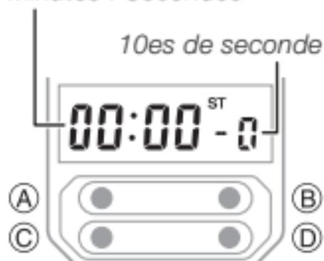
Le mode chronomètre permet de mesurer le temps écoulé. La plage du chronomètre est de 59 minutes et 59,9 secondes.
