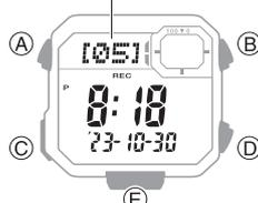
3. Tenere premuti (D) e (E) contemporaneamente per almeno due secondi. Rilasciare i pulsanti quando [CLR] smette di lampeggiare. I dati visualizzati vengono eliminati.
