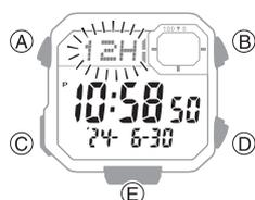
4. Premere (D) per passare da [12H] (formato di indicazione dell'ora a 12 ore) a [24H] (formato di indicazione dell'ora a 24 ore) e viceversa.
