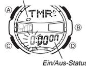
1. Während die Countdown-Startzeit auf dem Display im Countdown-Timer-Modus angezeigt wird, halten Sie den Knopf (A) gedrückt, bis die Stundeneinstellung der Countdown-Startzeit zu blinken beginnt, wodurch die Einstellanzeige angezeigt wird.
