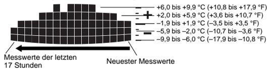
Die horizontale Achse der Grafik ist die Zeitachse. Die Säule ganz rechts Rand bildet der jüngste gespeicherte Temperaturwert und die Säule ganz links der 17 Stunden zurückliegende älteste Wert (1 Säule = 1 Stunde). Auf der vertikalen Achse der Grafik ist die relative Änderung von einer Stunde zur nächsten dargestellt.
