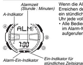
Wenn die Alarmfunktion eingeschaltet ist, ertönt auf Erreichen der Alarmzeit ein Piepsignal. Sie können auch ein stündliches Zeitsignal ausgeben lassen, bei dem die Uhr jede volle Stunde mit zwei Pieptönen meldet.
