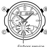
1. En mode Indication de l'heure, appuyez environ cinq secondes sur (A) jusqu'à ce que la montre bipé deux fois et le code de ville se mette à clignoter dans la partie supérieure de l'afficheur. C'est le mode de réglage.
