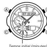
1. Lorsque le temps initial du compte à rebours est affiché en mode Minuterie à compte à rebours, appuyez environ trois secondes sur (A) jusqu'à ce que le réglage des minutes du temps initial du compte à rebours se mette à clignoter. C'est le mode de réglage.
