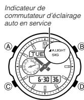
Une DEL (diode électroluminescente) éclaire l'afficheur de la montre pour qu'il soit mieux visible à l'obscurité. Le commutateur d'éclairage auto de la montre s'active lorsque vous tournez la montre vers votre visage, et à ce moment l'afficheur s'éclaire.
