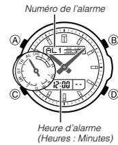
Lorsqu'une alarme est en service, une tonalité retentit à l'heure spécifiée pour cette alarme. L'une des alarmes est une alarme snooze et les quatre autres sont des alarmes uniques. Vous pouvez aussi mettre en service un signal horaire qui marquera le changement d'heure par deux bips.
