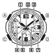
Les lettres (A) à (D) sur l'illustration indiquent les boutons utilisés pour les différentes opérations.
