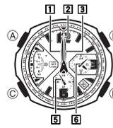
3. Après vous être assuré que la Trotteuse 2 était à sa position d'origine correcte, appuyez sur C. Vous pouvez maintenant réajuster la position d'origine de l'Aiguille des heures 1 et de l'Aiguille des minutes 3.
