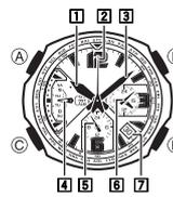
1. Appuyez au moins deux secondes sur C jusqu'à ce que la Trotteuse 2 s'arrête puis se remette à bouger.
