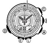
En el modo de altímetro, la parte de la esfera del reloj comprendida entre las 11 y las 7 horas actúa como escala de diferencia de altitud. La manecilla de segundos apunta hacia un punto de la escala que indica la diferencia entre la altitud que usted introdujo en el punto de inicio y la altitud de su posición actual. La indicación de diferencia de altitud se actualiza cada vez que el reloj toma una lectura de altitud.
