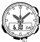
La esfera del reloj se ilumina para facilitar la lectura en la oscuridad. Cuando incline el reloj hacia su cara, el interruptor de luz automática del reloj encenderá automáticamente la iluminación.
