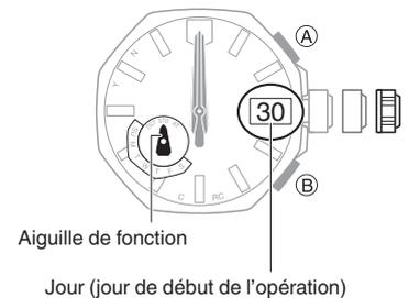
4. Si l'aiguille de fonction et/ou l'indicateur du jour ne sont pas alignés, faites tourner la couronne pour les régler. Déplacez l'aiguille de fonction sur 12 heures et/ou l'indicateur de jour au centre de la fenêtre de l'indicateur.
