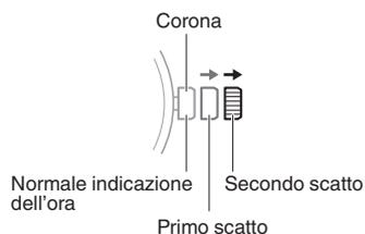
Dopo aver estratto la corona al primo o secondo clic, ruotarla in rapida successione in un senso o nell'altro per avviare un'operazione di avanzamento o riavvolgimento rapido. Mentre è in corso un'operazione di avanzamento rapido, è possibile ruotare nuovamente la corona in successione per aumentare la velocità.
