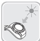
Quando si indossa l'orologio, assicurarsi che il quadrante (pannello solare) riceva la luce e non sia coperto dalla manica dei vestiti. L'efficienza di generazione dell'energia è ridotta anche quando il quadrante dell'orologio è coperto solo parzialmente.
