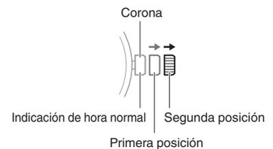
Después de extraer la corona hasta que suene el primer o segundo clic, si la gira rápidamente de manera sucesiva en cualquier sentido, se iniciará la operación de avance o retroceso rápido. Mientras realiza una operación de avance rápido, si vuelve a girar la corona rápidamente de manera sucesiva, aumentará aún más la velocidad.
