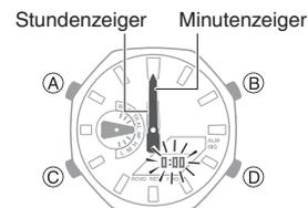
5. Wenn sich Stunden- und Minutenzeiger nicht auf 12 Uhr befinden, verwenden Sie (B) und (D), um sie auszurichten.
