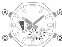
Si le niveau de charge baisse davantage, l'icône [CHG] clignote et les aiguilles des heures et des minutes se figent sur 12 heures. Dans ce cas, toutes les fonctions sont désactivées.
