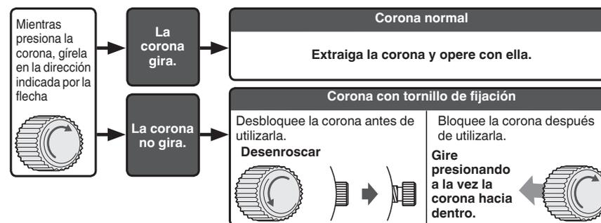
\* Bloqueando la corona mediante un tornillo, la corona de rosca puede prevenir el mal funcionamiento y aumentar la resistencia al agua.
