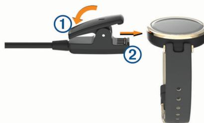
2 Alinea el clip con los contactos ② y suelta los anclajes.
