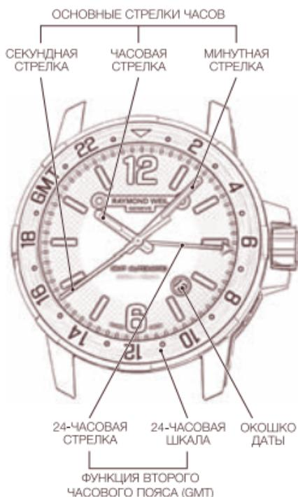
На ободке стекла часов **Nabucco** GMT выгравирована 24-часовая шкала. На этой шкале при помощи 24-часовой стрелки отображается время второго часового пояса.
