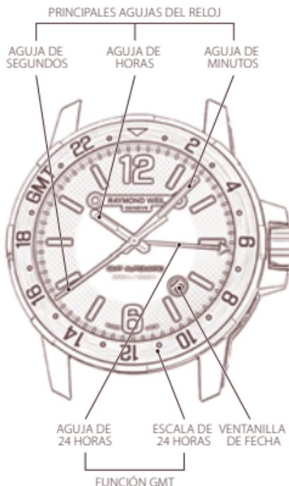
El bisel del **Nabucco** GMT tiene grabada una escala de 24 horas que le permite visualizar un segundo huso horario en el que se lee la hora gracias a la aguja de 24 horas.
