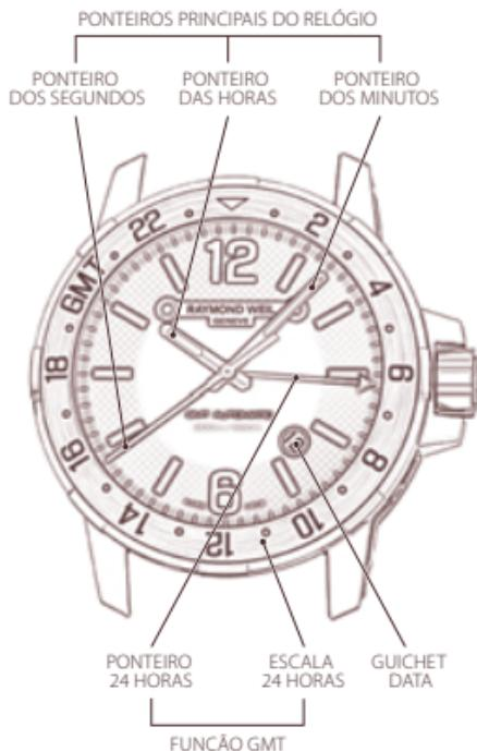
O aro giratório do **Nabucco** GMT possui uma escala de 24 horas gravada. Esta escala permite-lhe visualizar um segundo fuso horário, lido graças ao ponteiro das 24 horas.
