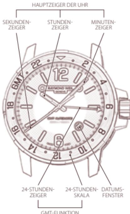
Auf der Lünette der **Nabucco** GMT befindet sich eine gravierte 24-Stunden-Skala, anhand derer Sie über den 24-Stundenzeiger die Uhrzeit in einer weiteren Zeitzone ablesen können.
