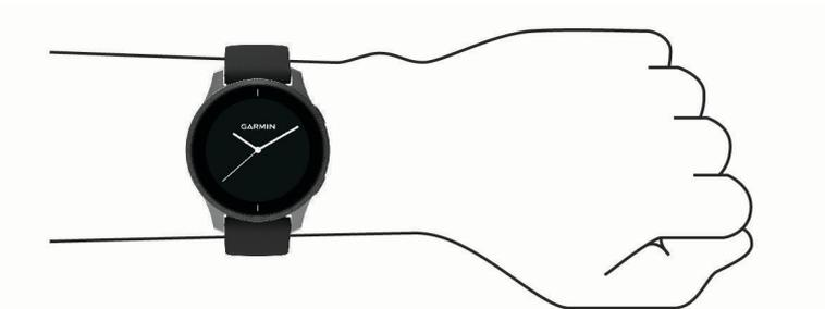
**NOTA:** il sensore ottico è situato sul retro del dispositivo.
